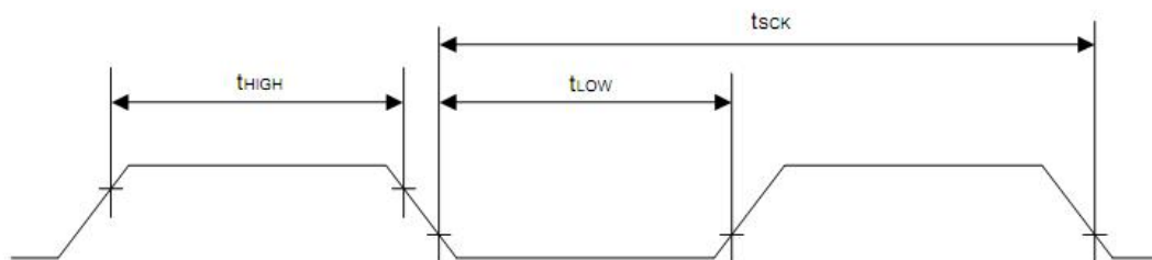
图 3-3 UART1/2 时序特性波形图
