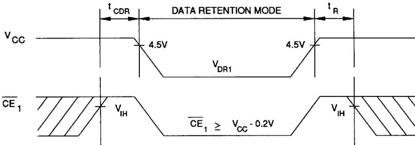
Data Retention Waveform 2 (CE<sub>2</sub> Control)
