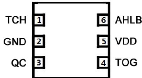
APS8233C, DFN6L (2\*2\*0.75mm), CMOS 输出(QC), 16 秒
