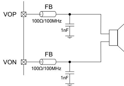
如果 ANT3118 应用于 EMI 要求比较高的系统中，可以在输出端串接 LC 滤波器的方式，如下图示：
