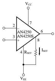
$$I_{SET} \cong \frac{V_{CC} + |V_{EE}| - 0.5}{R_{SET}}$$
