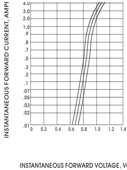
Fig. 2- TYPICAL INSTANTANEOUS FORWARD CHARACTERISTICS (25°C)
