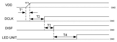
$T1 \le 20 \text{ ms}$   $T2 \ge 50 \text{ ms}$   $T3 \ge 1 \text{ ms}$   $T4 \ge 200 \text{ ms}$
