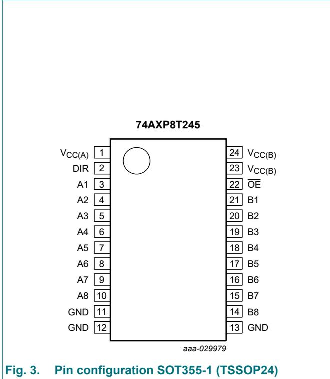
Fig. 3. Pin configuration SOT355-1 (TSSOP24)
