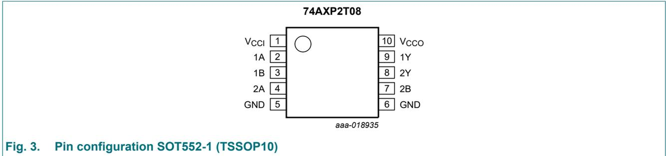
Fig. 3. Pin configuration SOT552-1 (TSSOP10)
