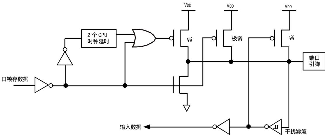
尽管 STC12LE2052 系列单片机为 3V 器件, 但引脚可承受 5V 电压。在准双向口模式中, 如果用户在引脚加上 5V 电压, 将会有电流从引脚流向 VDD, 这样导致额外的功率消耗。因此, 建议不要在准双向口模式中向 3V 单片机引脚施加 5V 电压。
