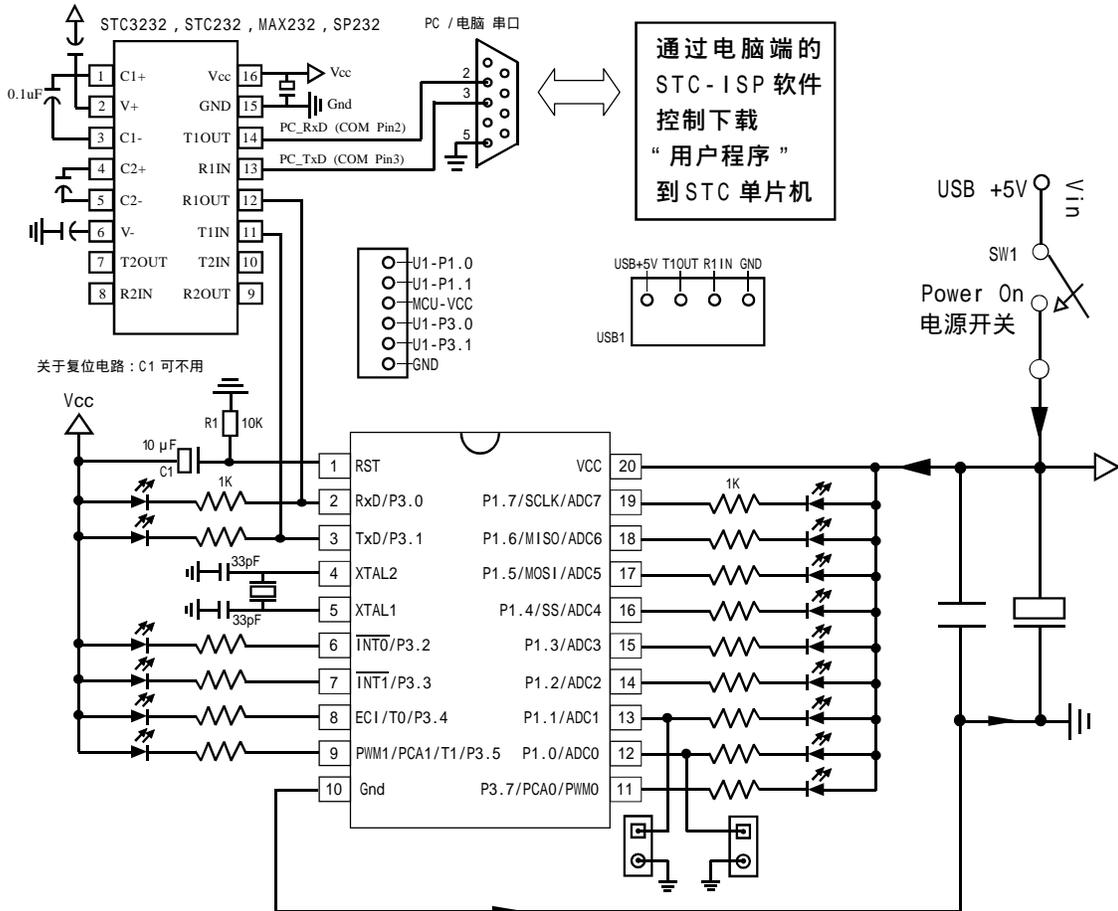
STC12C2052AD 系列单片机具有在系统可编程 (ISP) 特性, ISP 的好处是: 省去购买通用编程器, 单片机在用户系统上即可下载 / 烧录用户程序, 而无须将单片机从已生产好的产品上拆下, 再用通用编程器将程序代码烧录进单片机内部。有些程序尚未定型的产品可以一边生产, 一边完善, 加快了产品进入市场的速度, 减小了新产品由于软件缺陷带来的风险。由于可以在用户的目标系统上将程序直接下载进单片机看运行结果对错, 故无须仿真器。
