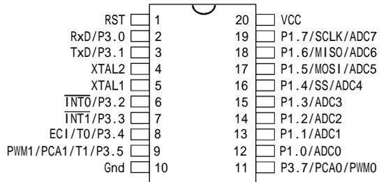
DIP-20, SOP-20, (超小封装 TSSOP-20 定货)
