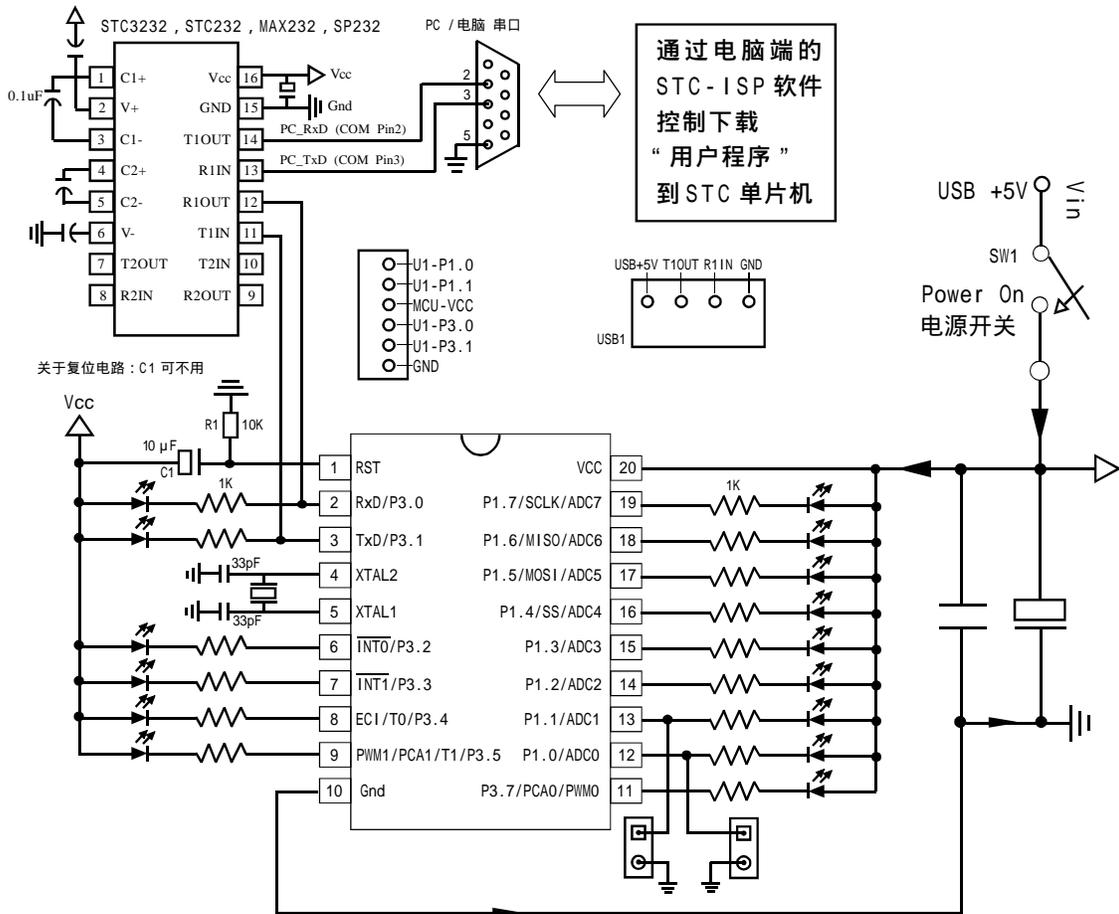
用户在自己的目标系统上，如将 P3.0/P3.1 经过 RS-232 电平转换器 转换后连接到电脑的普通 RS-232 串口，就可以在系统编程 / 升级用户软件。建议如果用户板上无 RS-232 电平转换器，应引出一个插座，含 Gnd / P3.1 / P3.0 / Vcc 四个信号线，当然如能引出 Gnd / P3.1 / P3.0 / Vcc / P1.1 / P1.0 六个信号线为最好，这样就可以在用户系统上直接编程了。关于 ISP 编程的原理及应用指南详见“STC12C2052AD 系列单片机 ISP 编程原理 使用说明”部分。另外我们有标准化的编程下载工具，用户可以在上面编程后再插到目标系统上，也可以借用它上面的 RS-232 电平转换器连接到电脑，以做下载编程之用。编程一个芯片大致需 2 秒到 3 秒钟，速度比普通的通用编程器快很多，故无须买通用编程器。
