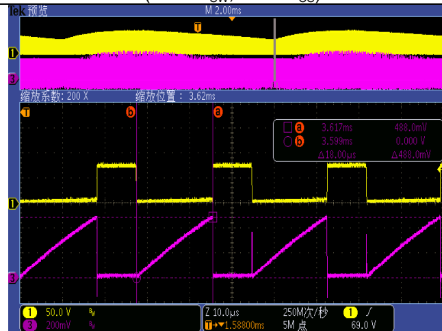
占空比和CS工作波形 (CH1= V_{SW} , CH2= V_{CS} )
